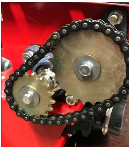
Рис.87 Звездочка 24 зуба для установки на вал ворошилки дозатора.
