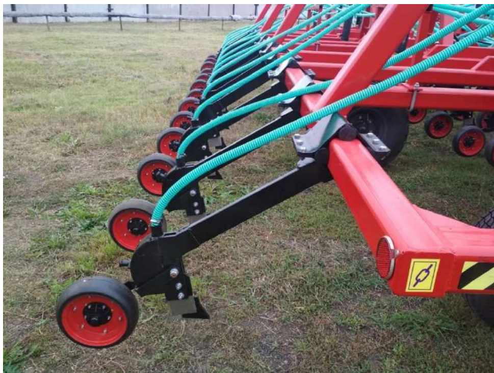
Рис.124 Анкерный демпферный сошник КПК-990А.11.00.000 сеялки КПК-990А.
