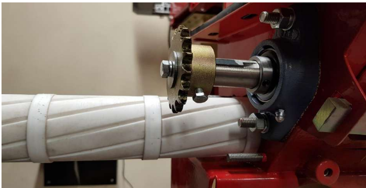
Рис.105 Замена дозирующих катушек.
