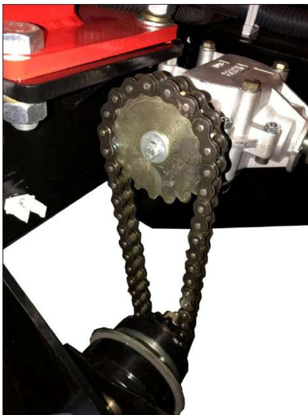
Рис.91 Звездочка 18 зубьев установлена на вал редуктора для понижения нормы высева.
