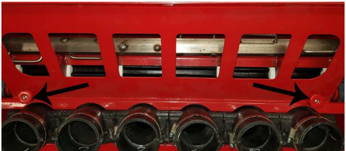
Рис.93 Винты для регулировки зазора между порогом и катушками.
