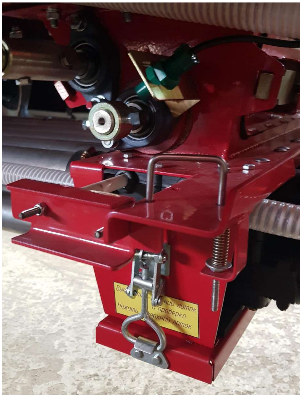
Рис.99 Положение шибберной заслонки, при подаче семян или удобрений в нижние трубопроводы и при тарировке нормы высева двенадцати канального дозатора.
