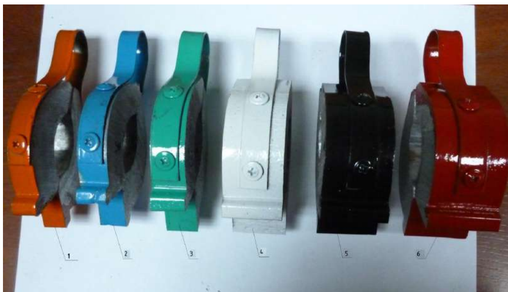
Рис.125 Набор клипс для регулировки глубины обработки культиваторной части посевного комплекса и фиксации гидроцилиндров в транспортном положении.
