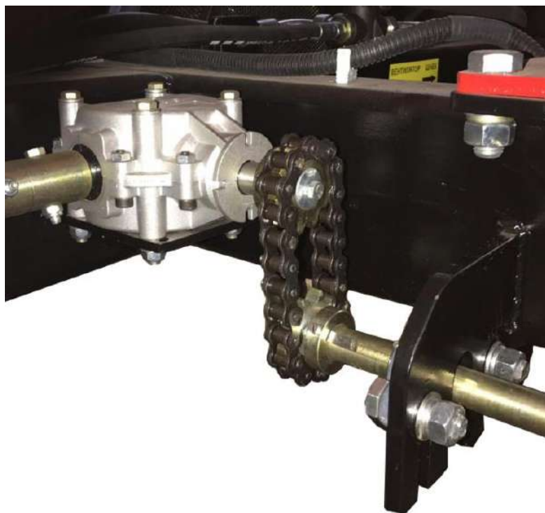
Рис.83 Звездочки 10-10 и цепь 36 звеньев и соединение
