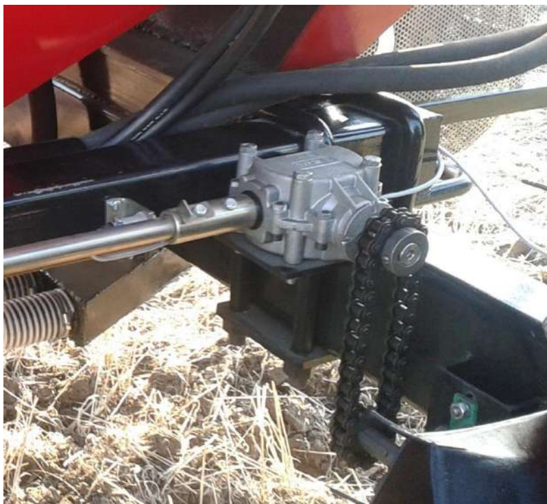
Рис.79 Электромагнитная муфта привода дозаторов, бункера ПБ-6-2, ПБ-10-2.
